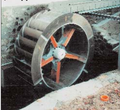
TURAS Wasserrad mit integriertem Getriebe (Struppmühle Giessen/BRD)
